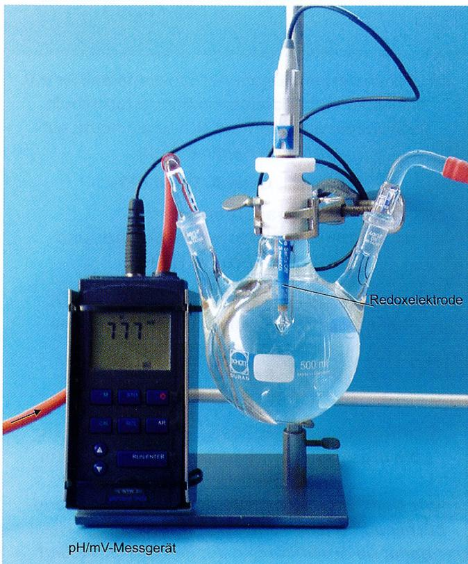
Abb. 3. Messung der Redoxspannung in einem geschlossenen Durchlaufgefäß nach DIN 38404 – Teil 6 [5]
