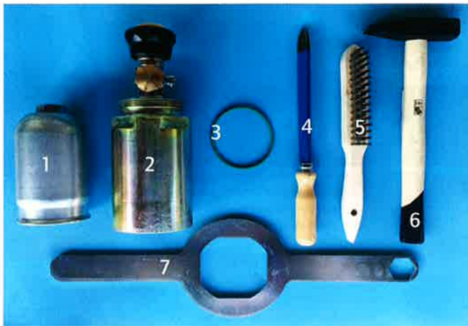
Abb.4. Notfallkappe mit Zubehör (1:Schutzhülle, 2:Chlornotfallkappe, 3:Ersatzdichtring, 4:Dreikantschaber, 5:Drahtbürste, 6:Hammer, 7:Ringschlüssel)
