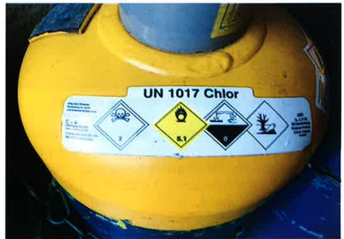
Abb.3. Gelbe Farbcodierung und Kennzeichnung von Chlorgasflaschen nach ADR von links: Klasse 2 (giftiges Gas), Klasse 5.1 (oxidierender Stoff), Klasse 8 (ätzender Stoff), umweltgefährdender Stoff
